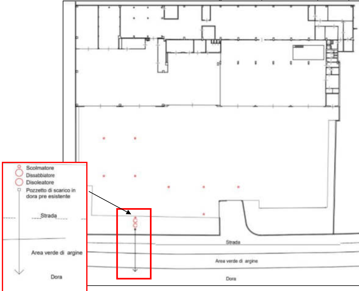
Planimetria impianto di smaltimento acque piovane
