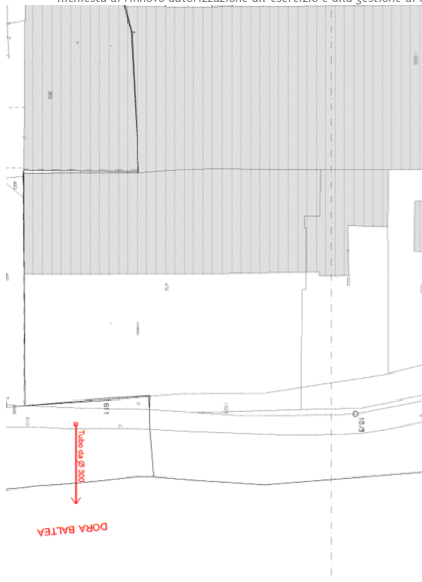
Dettaglio tubazione acque piovane sito Germanplast Srl
